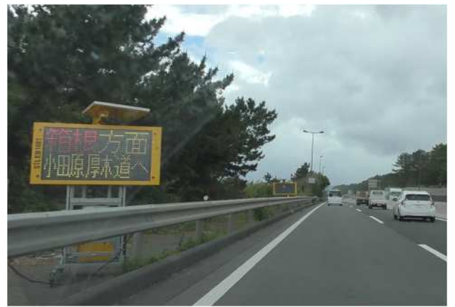
【簡易 LED 情報板による所要時間表示状況】
