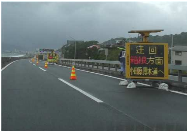
【簡易 LED 情報板による所要時間表示状況】
